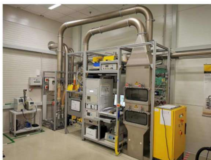
Stand de testare Topas PAF113 Utilizat in determinare căderii de presiune și cuantificarea capacității de reținere a elementelor filtrante
