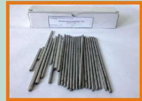
HEA Electrodes Ø8 mm
