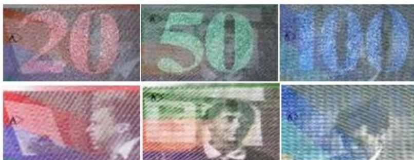
Fig. 3 Culorile de interferență ale tipăririi luciului perlat pe bancnotele elvețiene. Sus: cernelă perlata lucioasă, vizibilă în roșu, verde și albastru, în reflexie speculară. Partea inferioară: cernelă lucioasă perlata practic invizibilă în reflexie difuză.
