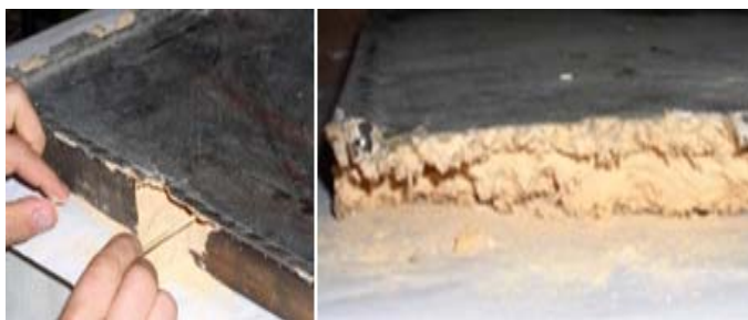
Fig. 9. Atac biologic, rupe structurile de rezistență din interiorul masei lemnoase, atac biologic masiv, scade greutatea masei lemnoase, care este chemată să susțină stratul pictural.
