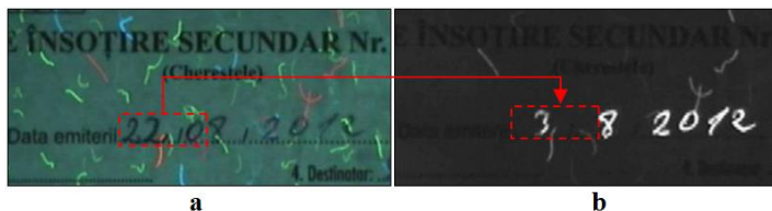
Fig. 3. Examinarea falsificării unui document în UV și IR
