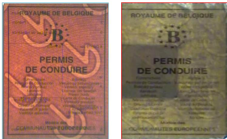
Fig. 14. Porțiuni din suportul documentelor (litigiu – stanga, specimen – dreapta), examinate în transparență – se observă diferențieri la nivelul detaliilor
