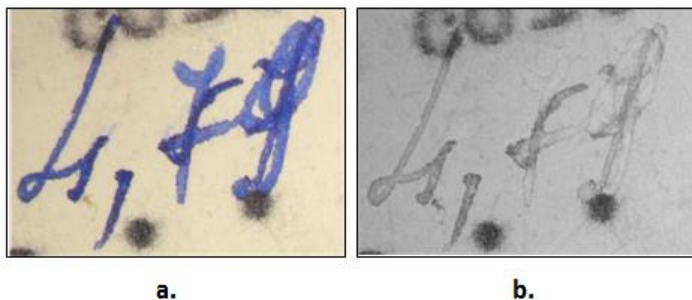
Fig. 1. Zone cu mențiune olografă dintr-un contract referitor la o suprafață de teren, unde ultimele două cifre prezintă trasee de modificare realizate cu o substanță de scris de nuanță diferită față de cea inițială: a. examinare în condiții obișnuite de vizualizare; b. analiza în lumină infraroșie
