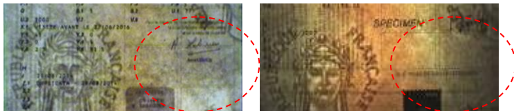
Fig. 9. Aspectul filigranului evidențiat prin examinarea suportului documentelor în lumină transmisă (litigiu – stanga, specimen – dreapta)
