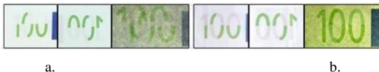
Fig. 20. Detalii ale unui element de suprapunere față-verso (reprezentând valoarea nominală a unei bancnote din cupiura de 100 €) vizibil prin examinarea în transparență a suporturilor de hârtie, în cazul litigiului – fals ( a. ) se observă lipsa continuității liniare a traseelor, spre deosebire de situația specimenului ( b. ) unde segmentele se îmbină perfect indicând valoarea
