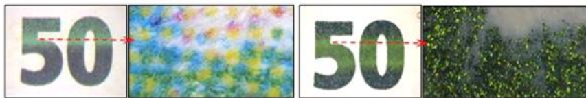
Fig. 5. Detalii macro, respectiv microscopice ale numărului care redă valoarea nominală a unei bancnote de 50 € - a. contrafăcută, b. - specimen, în care se observă existența unor asemănări cromatice la examinarea cu ochiul liber, în condițiile în care tehnicile de imprimare sunt diferite: în cazul litigiului sunt utilizate substanțe obișnuite de imprimare prin tehnica offset, iar în cazul specimenului este utilizată cerneală optic variabilă cu pigmenți metalici prin tehnica serigrafică
