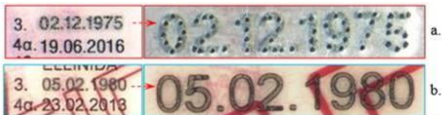
Fig. 9. Încercare de reproducere a efectului tactil prin realizarea unor trasee punctate în adâncime la suprafața suportului, fiind produse astfel margini de tipul bavurilor - în cazul datelor de personalizare din conținutul unui permis de conducere: a. în litigiu (fals total), respectiv b. specimen
