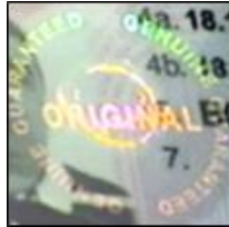
Fig. 18. Element de siguranță fantezist integrat în structura unui permis de conducere contrafăcut – acesta indică în mod expres apartenența la categoria produselor originale, (binînțeles fără a avea corespondent în structura specimenului)
