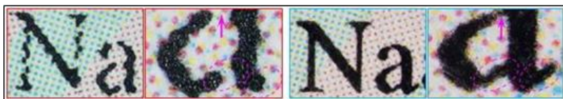
Fig. 3. Imagini microscopice cu desen de fond și date de personalizare de pe certificate de înmatriculare autentice, personalizate în unități diferite din cadrul unui stat membru UE (litigiu – stânga, specimen – dreapta), în care se observă aspectul particular diferit al elementelor componente ale caracterelor grafice și modul diferit de depunere pe suport a substanței de imprimare a acestora (desenul de fond este imprimat prin tehnica offset, iar personalizarea este realizată cu imprimantă laser)
