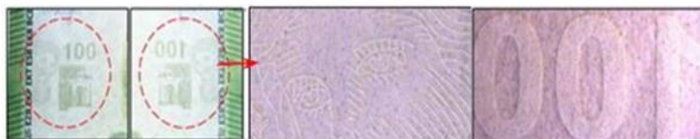
Fig. 7. Filigran fals realizat prin reproducerea imaginii originale în oglindă pe reversul unei bancnote de 100 € prin tehnica serigrafiei - după cum se observă în cele două cadre din partea dreaptă, iar la examinarea în contraproiecție de lumină imaginea este vizibilă și pe avers fiind produsă aparența de filigran autentic, după cum se observă în primul cadru din stânga
