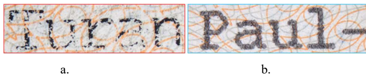
Fig. 10. Detalii microscopice în care se poate observa o situație de incompatibilitate a tehnicii de imprimare a datelor de personalizare cu suportul documentului în litigiu (a), respectiv compatibilitatea în cazul unui document specimen (b)
