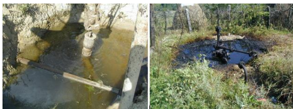
Fig. 26. Capuri de extracție pentru sonde eruptive, prost întreținute
