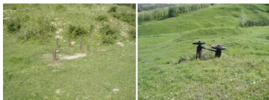
Fig. 24. Sistemul de scripeți în cruce sau de dedublare a șufelor, pe mai multe direcții, către sonde, astăzi abandonat
