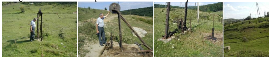
Fig. 23. Sondele vechi părăsite, unde se mai vede o șufă care ”trage sonda” cu un motor electric modern
