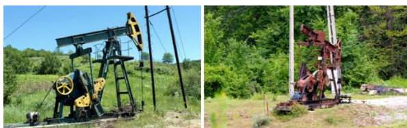
Fig. 30. Masturi cu volanturi ce pune în mișcare de pompare prin cal
