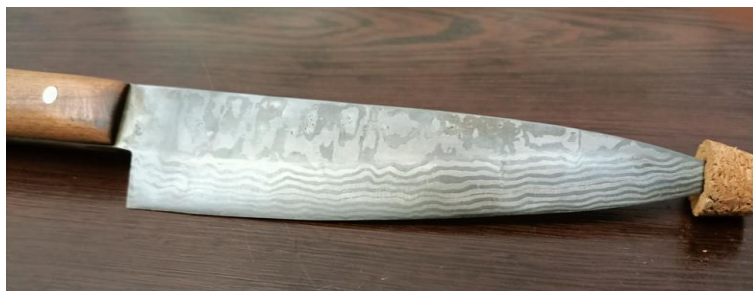
Fig. 1. Cuțit din oțel de Damasc
