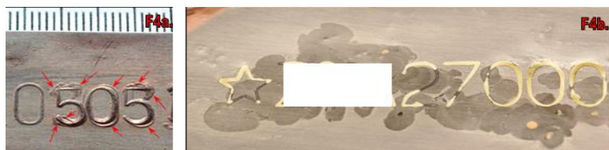
Fig. 4. Cadre care redau exemplificativ situații în care nu s-a reușit restabilirea seriei autentice, însă au fost identificate urme ale unor modificări neautorizate la nivelul caracterelor grafice inițiale
