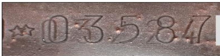
Fig. 6. Detaliu cu o secvență din seria de identificare, la finalul procesului de relevare, în care se observă caractere grafice din seria falsă, dublate de caracterele autentice
