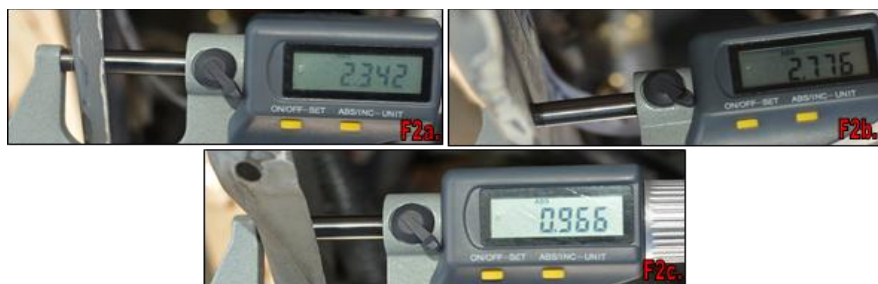
Fig. 2. Cadre care redau valori metrice cu diferențieri semnificative, obținute prin măsurători efectuate cu ajutorul șublerului electronic în puncte diferite din perimetrul seriei (F2a și F2b), respectiv în afara perimetrului (F2c.), diferențele nefiind explicabile decât prin modificările aduse stării inițiale
